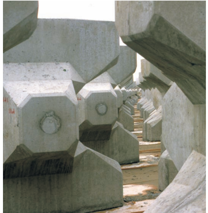
Blocs en béton préfabriqués pour la confection de digues et de quais.
