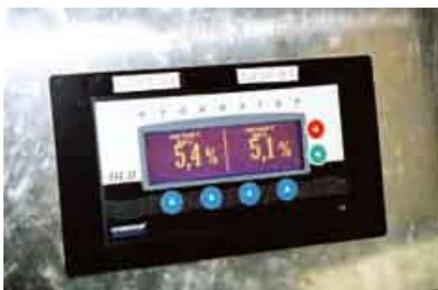
Indications des sondes hygrométriques des cases à sable
