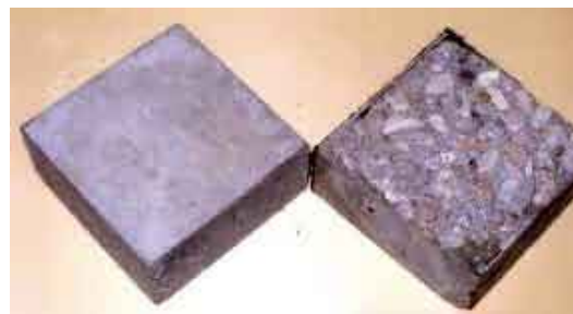
Essai de résistance à l'écaillage
