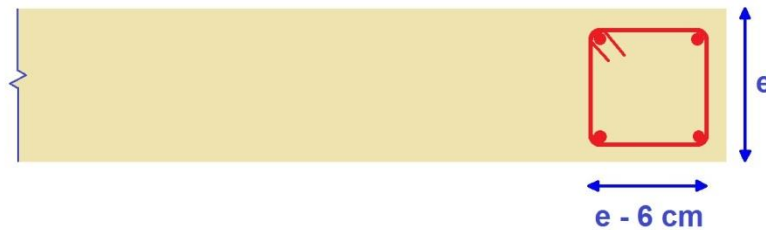
Figure 15 : Chainage sur les bords libres circulés
