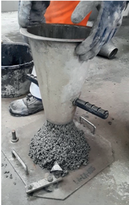
Figure 2. Illustration de l'essai d'aptitude à l'écoulement au cône inversé
