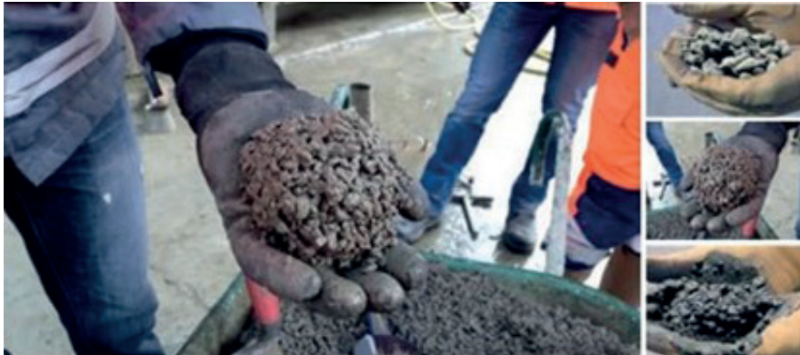
Figure 1. Illustration de l'essai à la boule (extrait guide CIMbéton T69).
