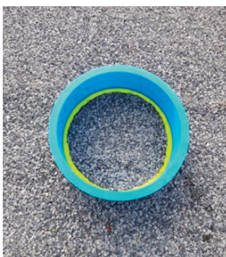
Figure 12. anneau de drainabilité étanché avec de la pâte à modeler.
