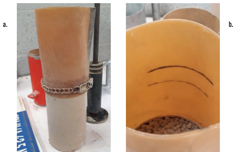
Figure 9. a) Exemple manchette souple, bridage avec chaînette - b) Exemple marquage du niveau à l'intérieur de la manchette (ici repéré par deux traits).
