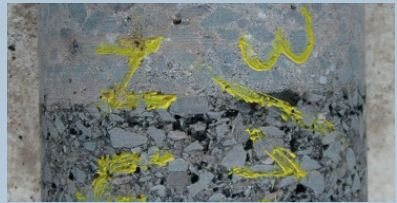
Carotte illustrant le très bon collage entre le béton et la grave bitume.
