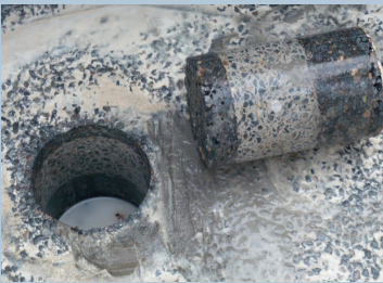
Carotte illustrant le très bon collage entre le béton et la grave bitume.
